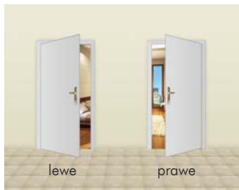
Drzwi otwierające się na zewnątrz
